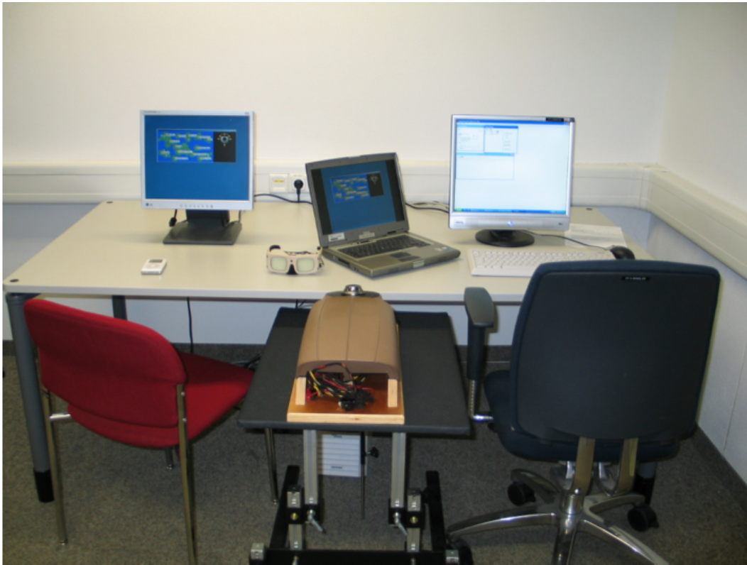
Abbildung 7.37: Versuchsaufbau zur vergleichenden Untersuchung mittels eines Okklusionstests im Usability Labor der BMW Forschung GmbH
