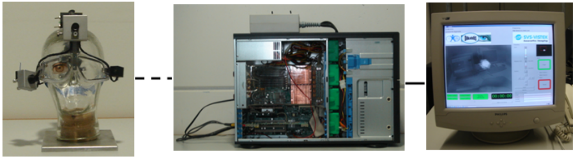
Abbildung 2.19: Funktionsprinzip des Blickerfassungssystems DIKABLIS [100]
