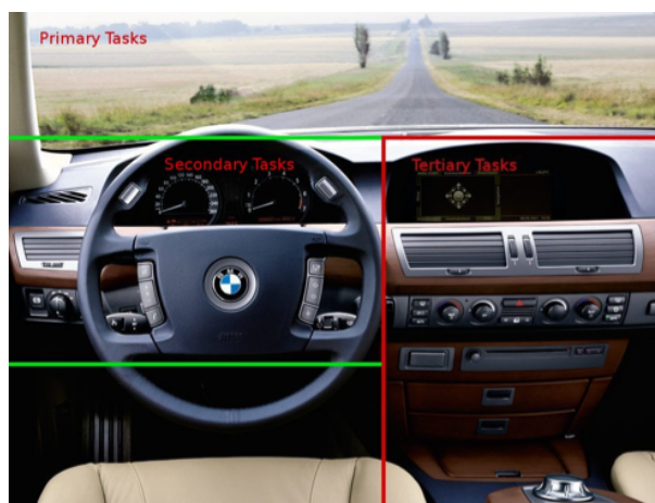
Abbildung 2.8: Räumliche Aufteilung des Cockpits eines BMW 7ers, Baujahr 2001, in separate Bereiche für primäre, sekundäre und tertiäre Funktionen [164].
