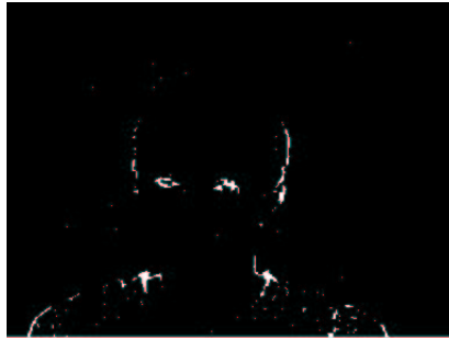
Abbildung 2.4: Differenzbild nach Threshold bei einem optimalen Lidschlag
