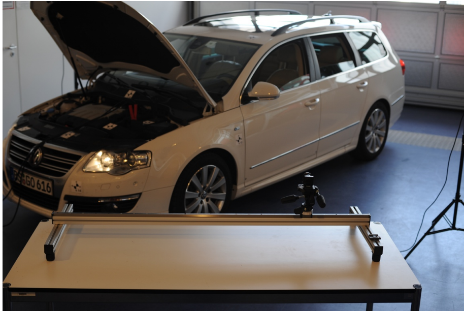
Abbildung 16: Die Länge einer Linearachse musste dadurch bestimmt werden, dass der Passat von einer Kamera, die auf der Schiene hin und her fuhr, getrackt wurde.
