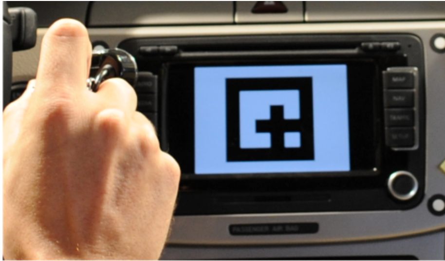
Abbildung 12: Ein Marker erscheint für 20 Sekunden im Navigationsdisplay. In dieser Zeit musste ad-hoc eine Feature Map aufgebaut und registriert werden.
