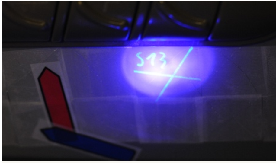
Abbildung 31: Messpunkt, der mit einer UV-Lampe sichtbar gemacht wurde. Die Klebpeile markieren die von den Trackern geschätzte Position.
