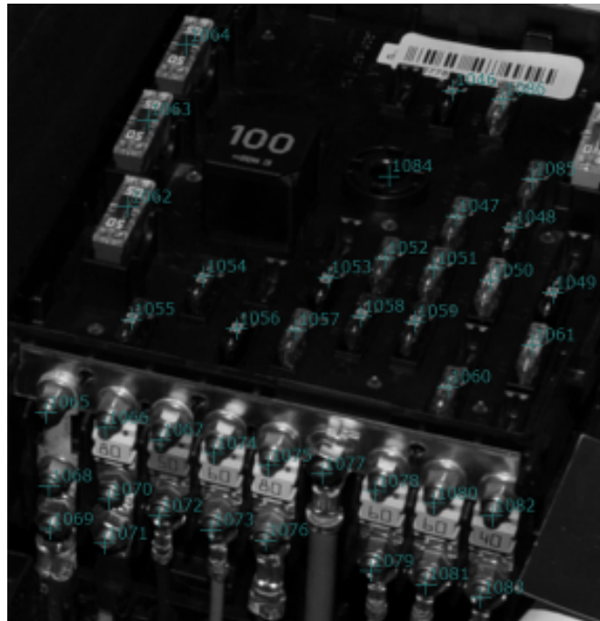
Abbildung 9: Kleine Sicherungen, die mit Hilfe eines AR Systems identifiziert werden mussten.
