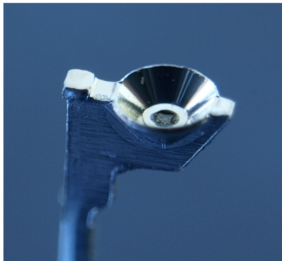
Abbildung 2.3: Reflektorwanne einer LED
