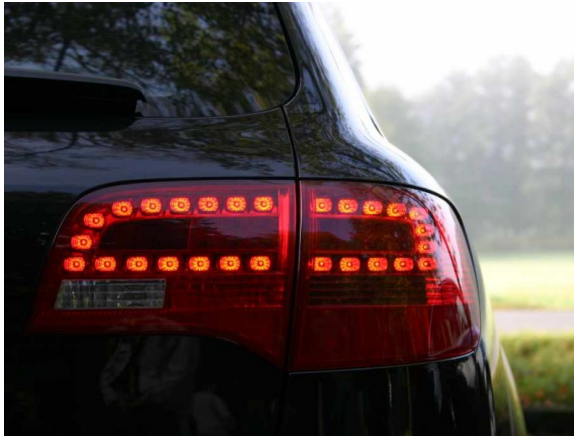
Abbildung 1.1: LED-Rücklicht eines Audi A6
