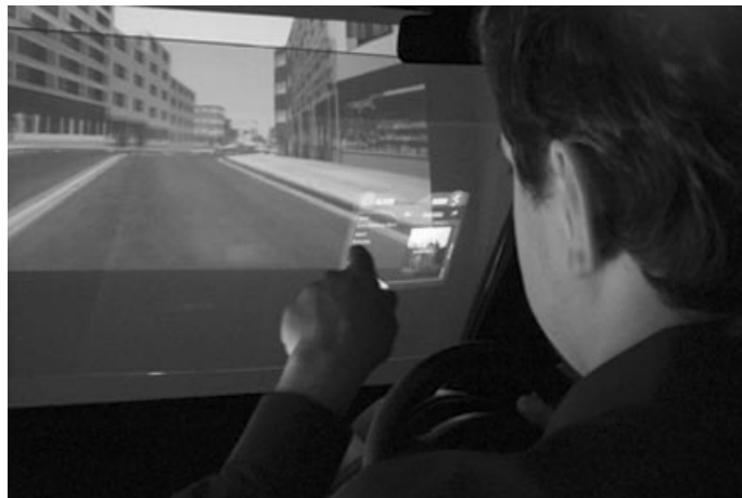
Abbildung 2.7.: Studie eines visionären MMI Konzept im Fahrzeug mit Head Up Display von Alpern et al. [AM02]. Als Erkennungstechnologie wurde ein „Wizard of Oz“ verwendet.
