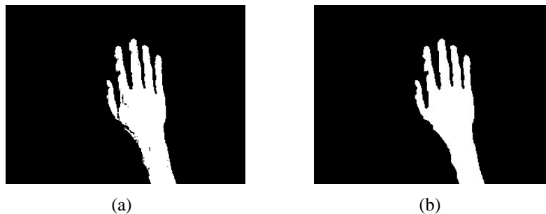
Abbildung 3.2.: Ungefiltertes Bild (a), Bereinigtes Bild (Geschlossene Löcher mit anschließendem Closing) (b).
