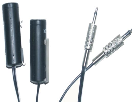
Abbildung 4.1: Vibratoren, Taktile-Ausgabegeräte
