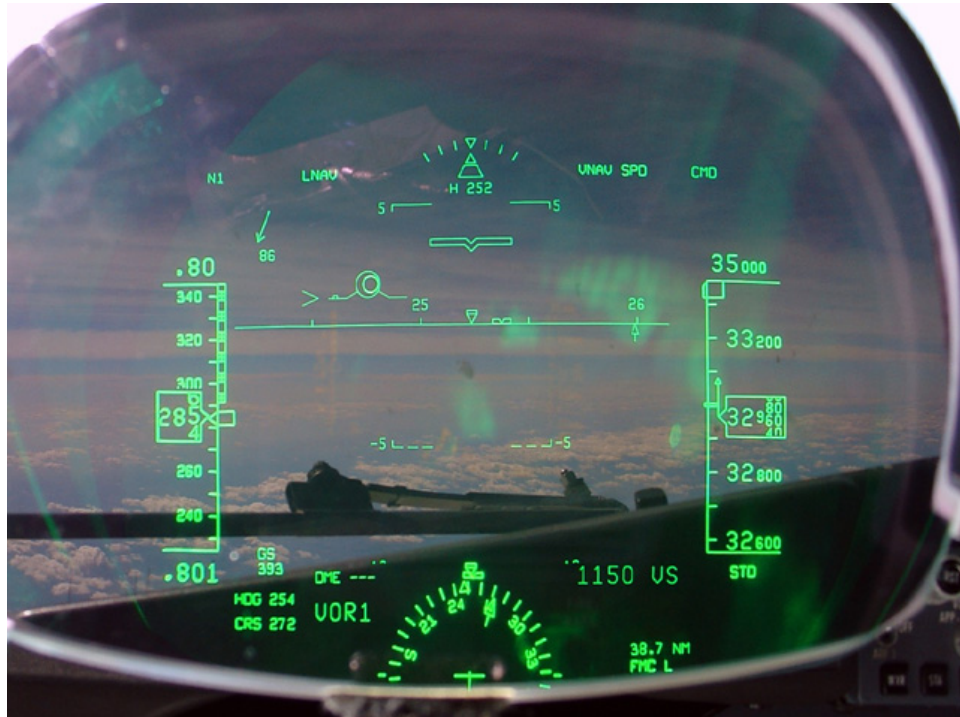
Abbildung 1.7: Ziviles Head Up Display einer Boeing 737-832; Foto: (c) Michael Ciasullo
