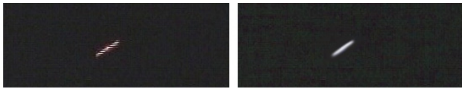
Abbildung 8.2: Verwischen der Marker bei sehr schneller Kamerabewegung a) interlaced b) non-interlaced
