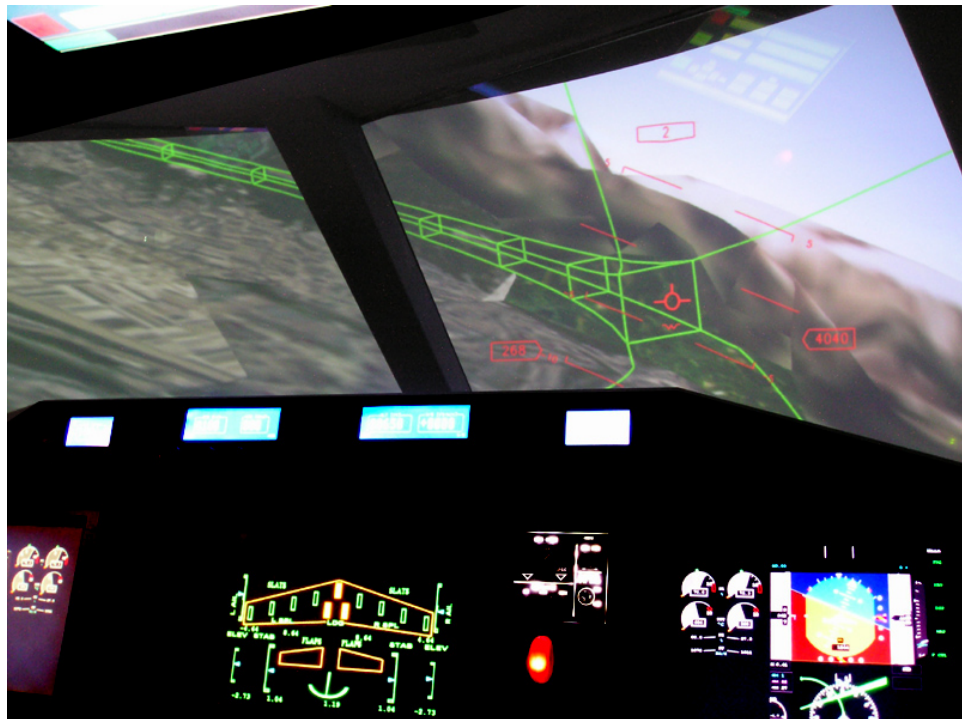
Abbildung 2.3: LFM Flugsimulator: Projektion des Tunnels mitsamt der Außensicht
