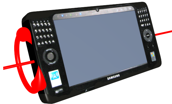
Abbildung 4.2: Änderung der Neigung durch Rotation um die Querachse.
