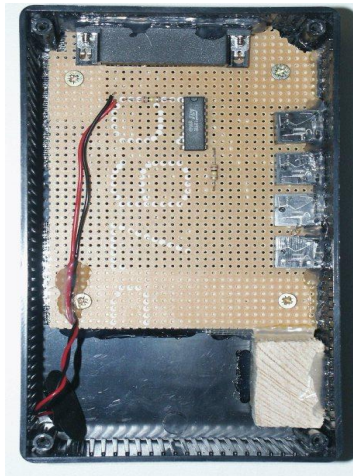
Abbildung A.3: Schaltbox mit Audioanschlüssen und LPT Steckplatz für die Verbindung zum Laptop. Ansicht von oben auf den eingelöteten Chip und das Batteriefach
